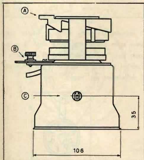
La messa a fuoco del cinescopio è ottenuta per mezzo di due anelli di ferroxdure magnetizzati in senso radiale e viene regolata variando il traferro esistente tra questi due anelli.
