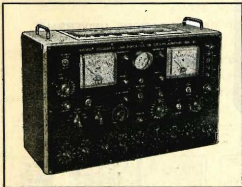
L'apparecchio è stato realizzato allo scopo di consentire al tecnico l'esame completo del funzionamento dei tubi elettronici in genere, in quanto oltre alla effettuazione dei normali controlli (isolamento catodo, continuità, corrente anodica ecc...) è consentita anche la visione della curva caratteristica  $I_a = f(V_g)$ , mediante l'oscilloscopio incorporato nell'apparecchio stesso.
