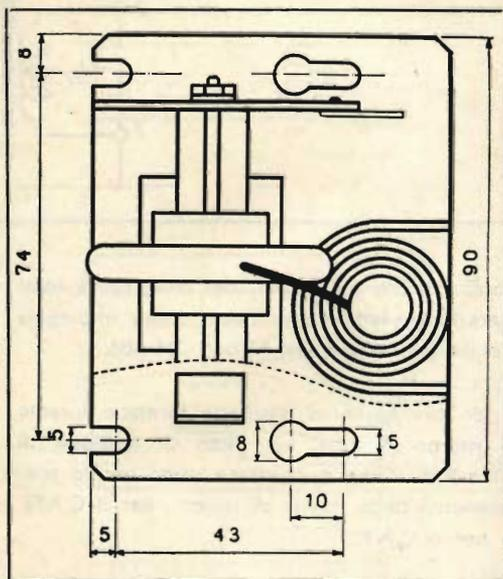
E' previsto per il pentodo finale PL 81: è il diodo PY 81 come booster. E' adattato all'unità di deflessione M/664 - BT 602 per cinescopi a
